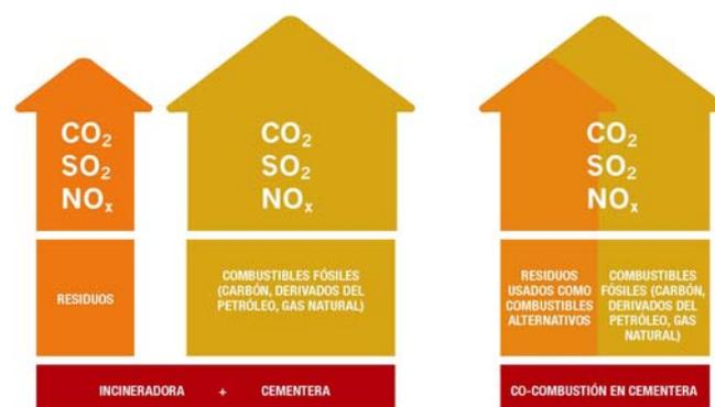
Figura 1: Recuperación de energía por la co-combustión en cementera
